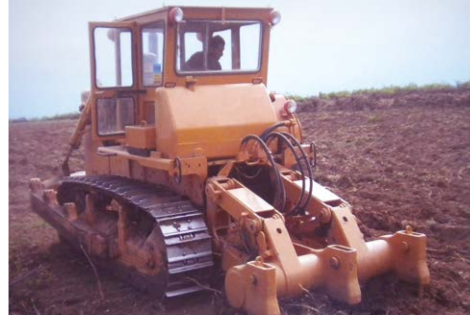
Şekil 13: Paletli traktöre monteli üçlü dip kazanla taban patlatma işleminin yapılması
